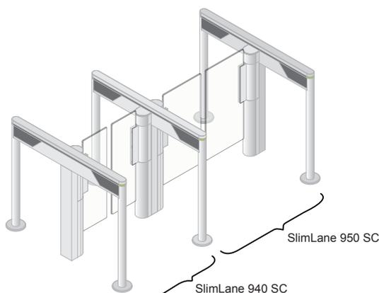
1. Châssis de la rambarde basé sur une poutre en acier traité contre la corrosion par électrozingage RoHS et des poteaux en acier inoxydable. La rambarde intègre les cellules photoélectriques de détection de présence de l'utilisateur et la logique de commande.
