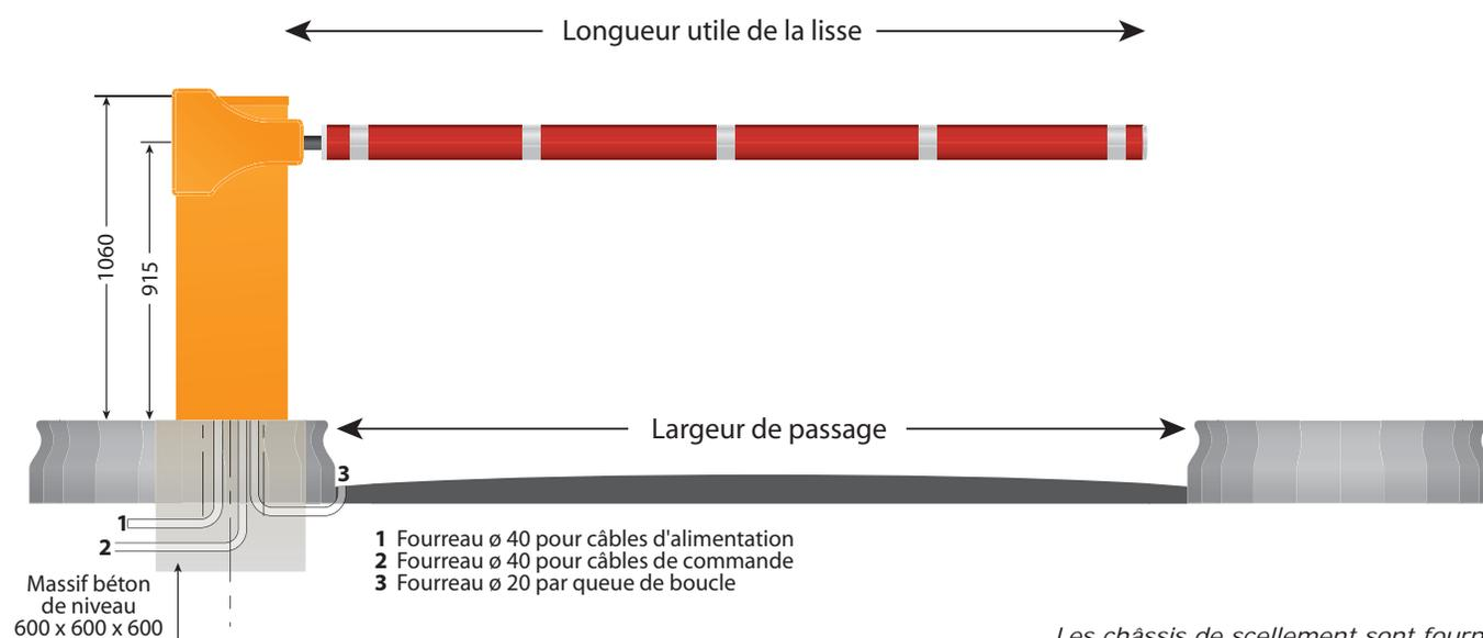
Les châssis de scellement sont fournis avec 4 écrous et 4 rondelles. Il est possible de fixer la barrière par des chevilles chimiques M12
