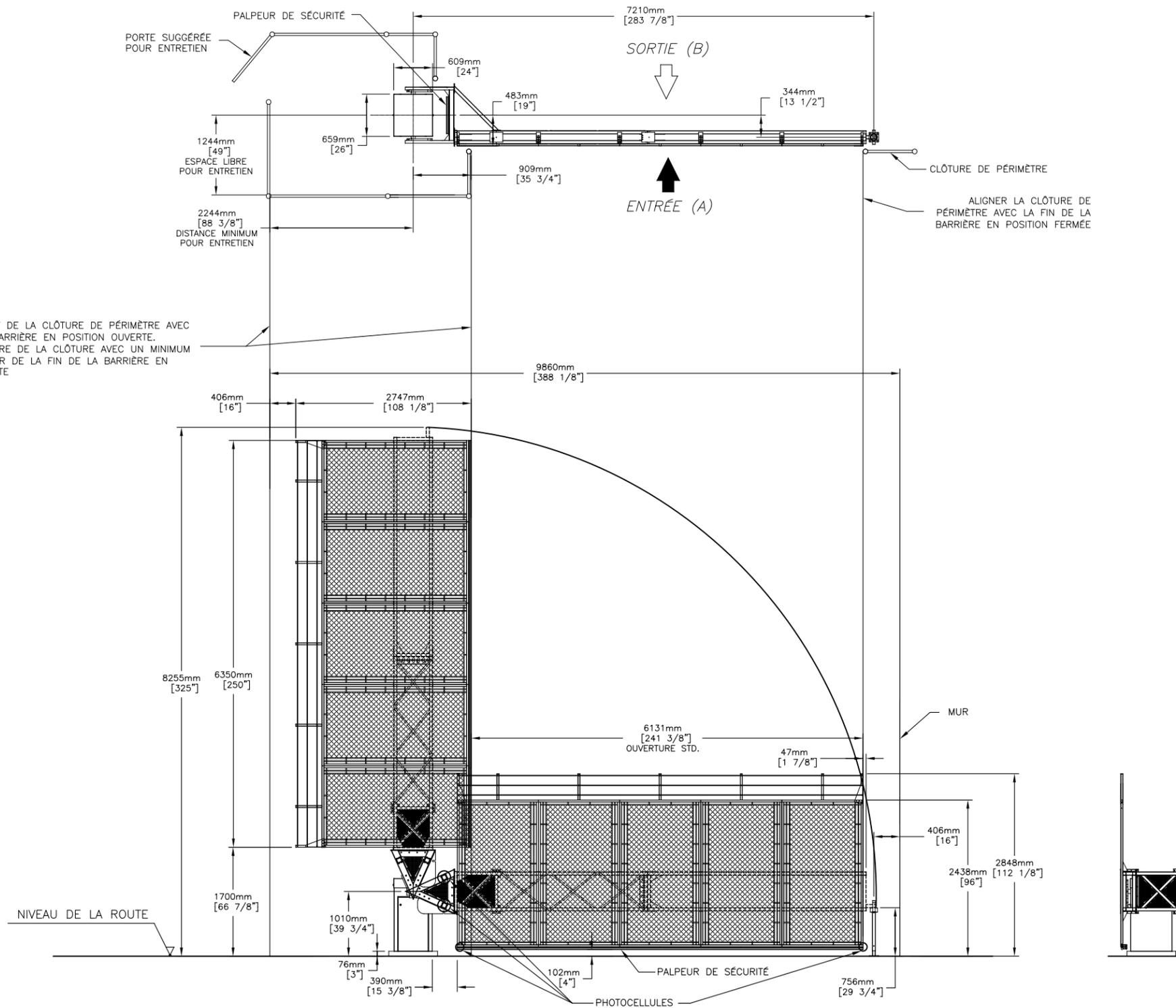
ALIGNER L'AVANT DE LA CLÔTURE DE PÉRIMÈTRE AVEC LA FIN DE LA BARRIÈRE EN POSITION OUVERTE.
